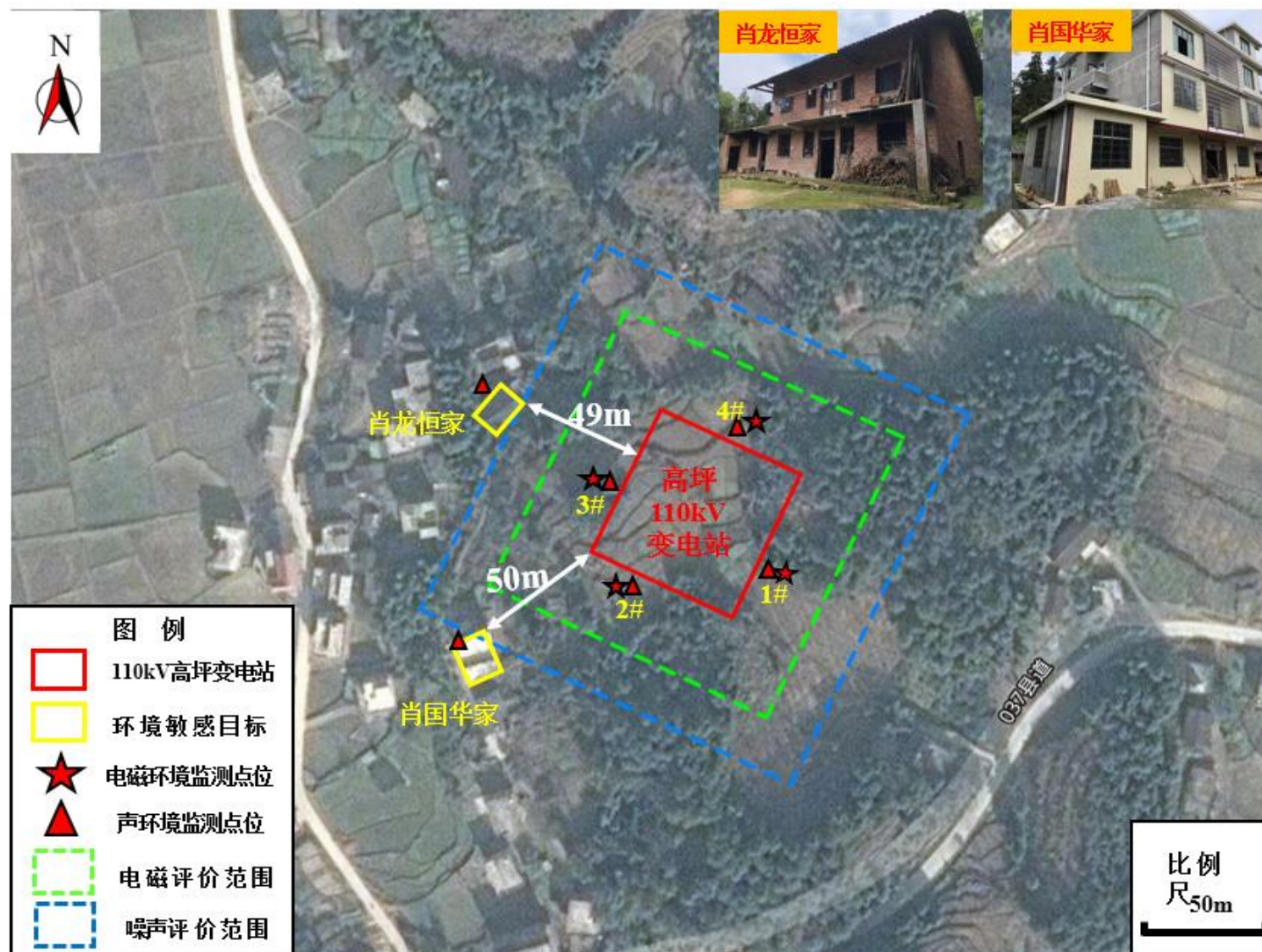
图 5 高坪 110kV 变电站周围各敏感点相对位置关系示意图
